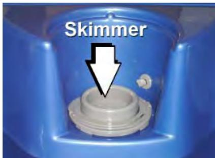
Pour nettoyer le filtre de skimmer, retirez la trappe d'accès qui couvre l'ensemble de la zone du filtre. Soulevez la partie centrale du skimmer jusqu'à ce qu'elle soit intégralement tendue. Maintenez la partie centrale et tournez-la dans le sens des aiguilles d'une montre jusqu'à ce que les plats du panier s'alignent avec les crochets de fixation. Tirez alors le panier vers le haut pour le retirer.
